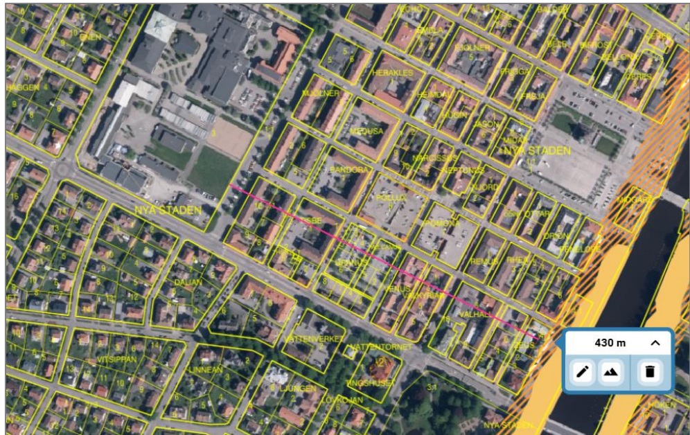
Figur 8. Utdrag ur SGU:s kartvisare "Förutsättningar för skred i finkornig jordart". Markering längs Lidan innebär "Aktksamhetsområde".
