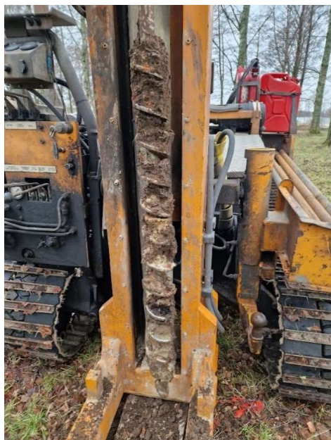
Figur 8. Skruvborr på första metern i provpunkt 24E08. Fyllnadsmaterial bestående av stenig, grusig sand.
