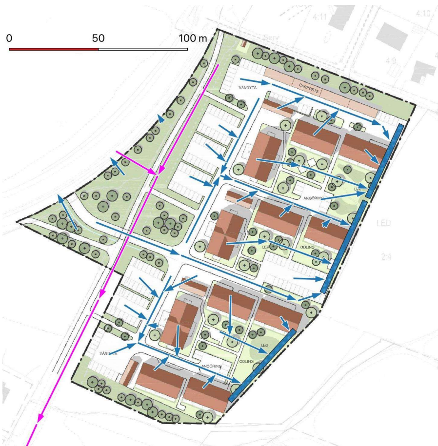
Figur 6: schematisk skiss över avledning inom planområdet (blå pilar) mot infiltrationsmagasin (blå rektanglar). (Efter skiss erhållen av Lidköpings kommun).
