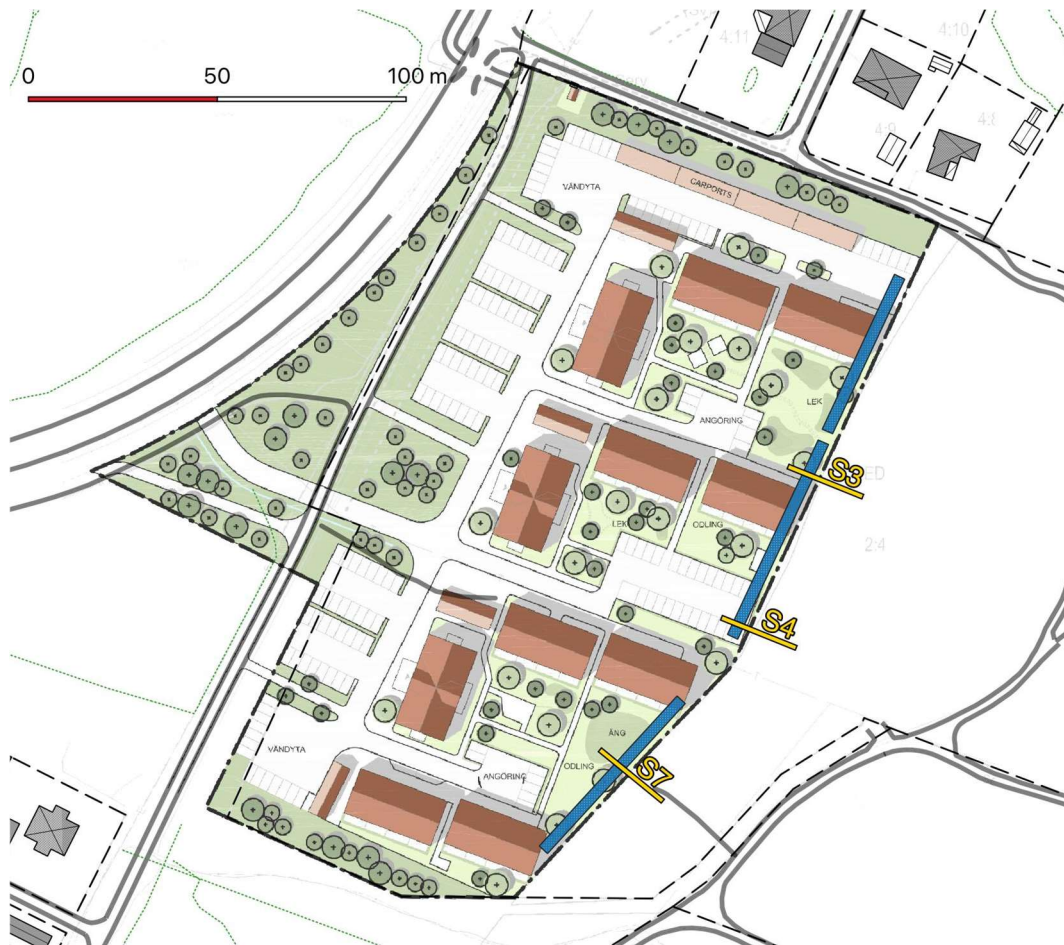
Figur 11: föreslagen placering av magasin som blå rutor samt läge för tvärsektioner enligt nedan med gula linjer.
