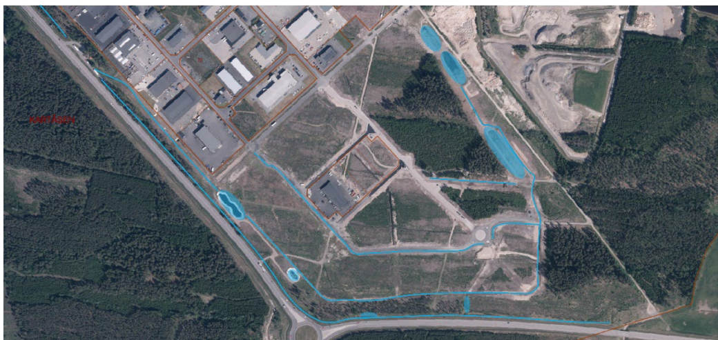
Figur 9 Schematisk illustration av det öppna dagvattensystemet i södra Kartåsen. Blå linjer är större diken, blå ytor är dagvattendammar för fördröjning
