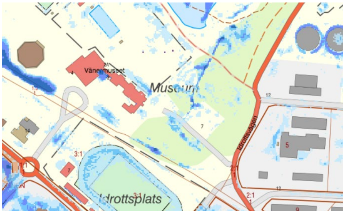
Figur 23 Klimatkompenserat (faktor 1,3) 100-års regn. Ljusblå ytor: 0,1-0,3 m stående vatten, besvärande framkomlighet. Mellanblå ytor: 0,3-0,5 m. Risk för stor skada, ingen möjlighet att ta sig fram med motorfordon. Mörkblå ytor: < 0,5 m. Risk för människors liv och hälsa.
