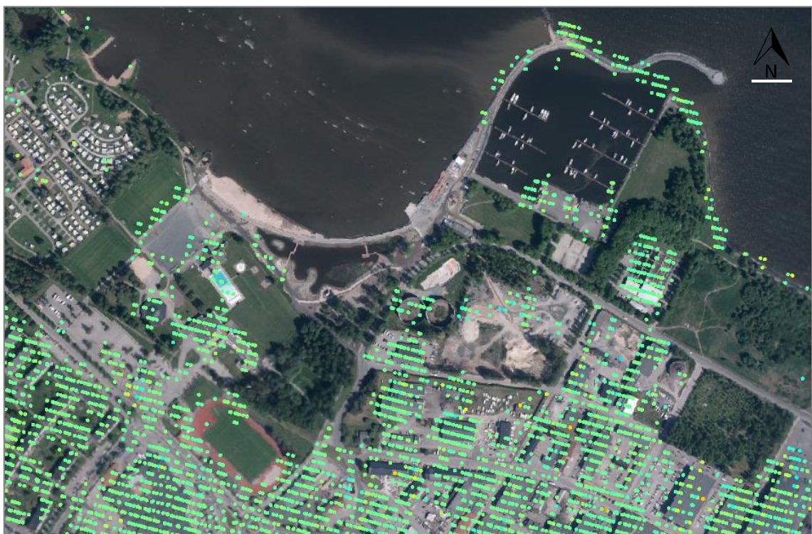
Figur 2. InSar-mätningar i närområdet.
