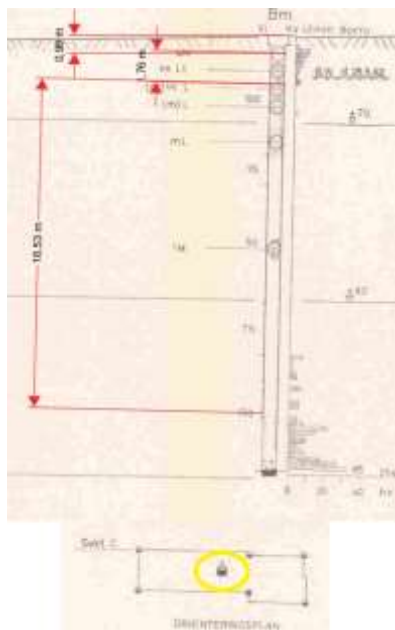
Figur 5. Urklipp ur sektionsritning inklusive djuptolkningar för Grundundersökning för projekterat kommunalhus i Vinninga kommun, Vinninga upprättad av AB Flygfältsbyrå daterad 1962-05-30.
