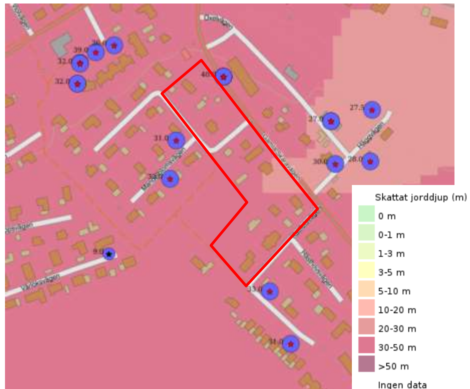
Figur 3. Utklipp ur SGU:s geologiska kartblad för skattat jorddjup. Aktuellt område nybyggnation rödmarkerat.
