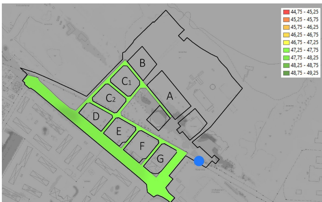
Figur 81 Schematisk karta som visar framkomlighet på gator vid översvämningar från Vänern. Samtliga gator planeras på säker nivå, över +47,25. Blå punkt markerar den plats där vattennivån bedöms kunna bli 0,20 meter vid ett 100-årsregn. Se också figur 82 för vattendjup på övriga gator vid skyfall.
