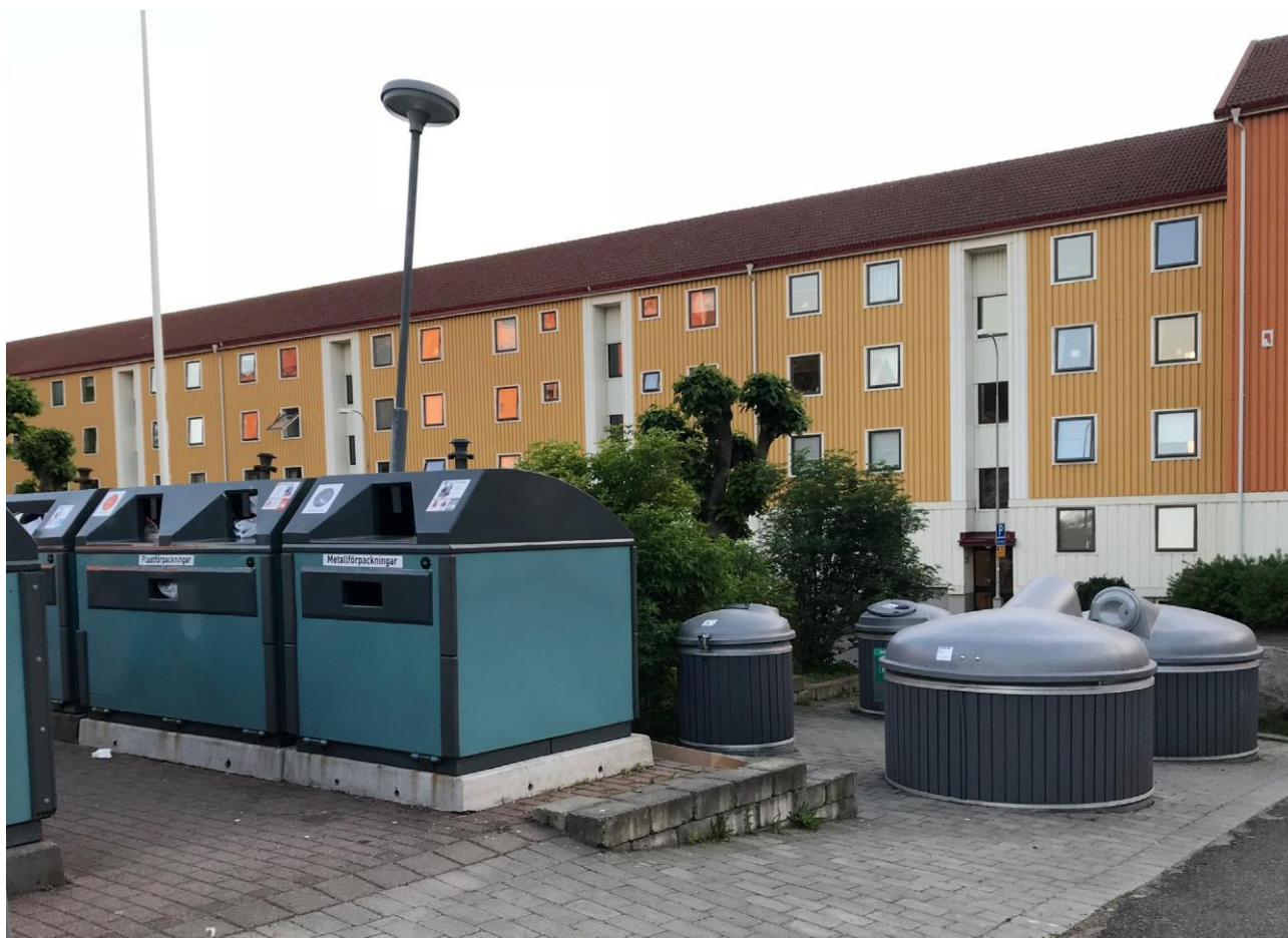
Bottentömmande behållare ovan mark (till vänster i bild) och underjordsbehållare med insatssäck (till höger i bild). FOTO: REBECCA JAKOBSSON, RAMBOLL.
