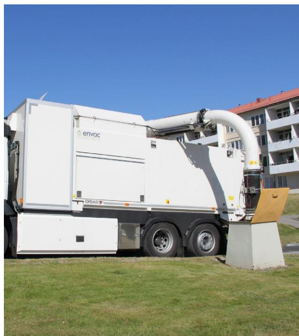
Mobil sopsug kopplad till en upphöjd dockningspunkt.
