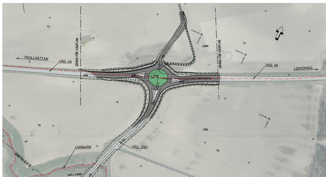
Figur 6. Planerad cirkulationsplats mellan väg 44 och väg 2561 (Bild från vägplan för väg 47/östra vägen förbifart Grästorp 2020).
