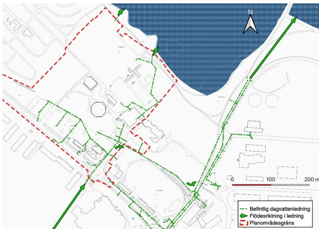
Figur 35 Befintlig avledning av dagvatten från planområdet (Melica, 2025).
