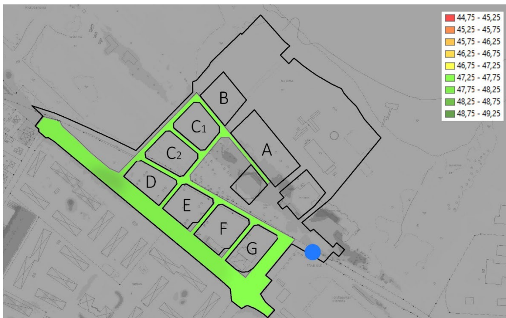
Figur 86 Schematisk karta som visar framkomlighet på gator vid översvämningar från Vänern. Samtliga gator planeras på säker nivå, över +47,25. Blå punkt markerar den plats där vattennivån bedöms kunna bli 0,20 meter vid ett 100-årsregn. Se också figur 88 för vattendjup på övriga gator vid skyfall.
